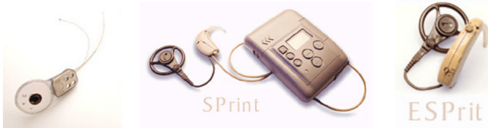
Fig. 2: a: parte interna dell'impianto cocleare; b: speech processor a scatola; c) nuovo speech processor retroauricolare
